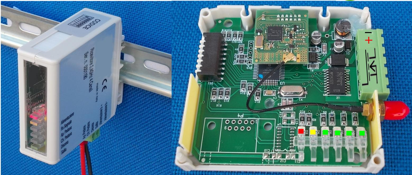
Il ricevitore è dotato di Dip Switch di codifica tra TX ed RX; Vi sono led di segnalazione Alimentazione , Segnale , Canali abilitati (salita - discesa- apertura e chiusura p.
